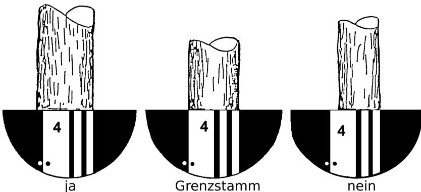
**Abbildung 5.3:** Winkelzählprobe — Zählerfaktor 4 mit Relaskopdurchblick (Skala: metrisch CP)
