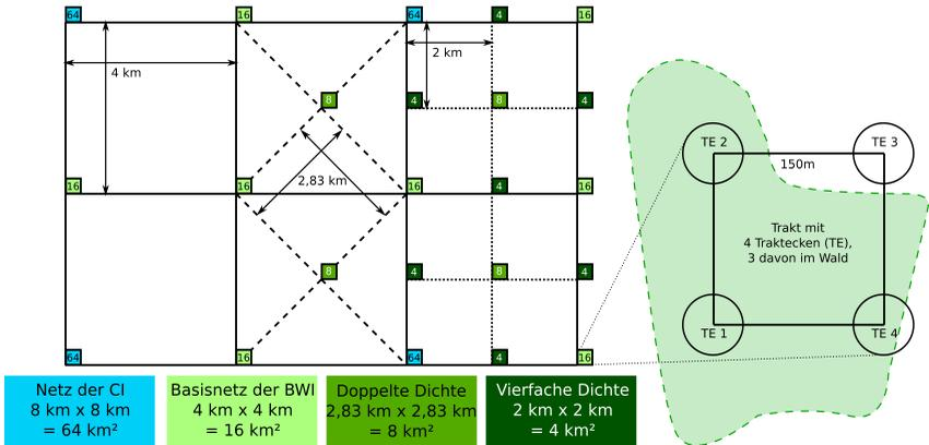
Abbildung 2.1: Stichprobennetz und Traktaufbau, - - - = Waldgrenze, TE = Traktecke
