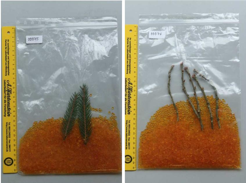
**Abbildung 6.1:** Tüten mit Proben und Trockengel, links: Zwei ca. 10 cm lange Zweigspitzen je Pflanze werden für die Nadelbaumarten beprobt, rechts: Fünf ca. 10 cm lange Zweigspitzen werden je Pflanze für die Laubbaumarten zwischen Blattwelke und Austrieb beprobt.
